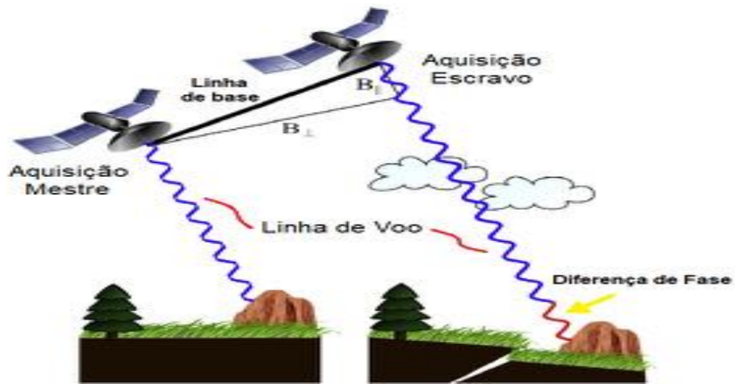
Figura 1. Princípio de operação interferométrica. Fonte: Osmanoglu, B. et al., (2016). Adaptado.
